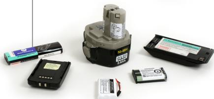
La pile à hydruure métallique de nickel est très performante dans les appareils énergivores et peut être rechargée jusqu'à 1 000 fois. Elle ne contient pas de cadmium, mais peut coûter cher.
